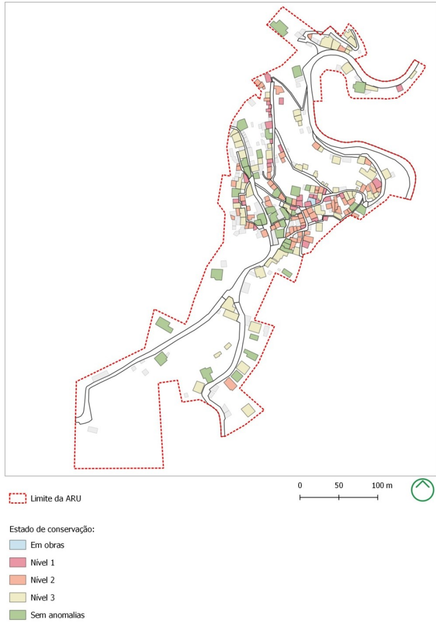
Figura 25 – Edificado na ARU-FC – estado de conservação.
